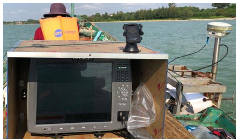
รูปที่ 3.4.7-2 : เครื่องหยั่งน้ำ HI-Target HD-MAX
