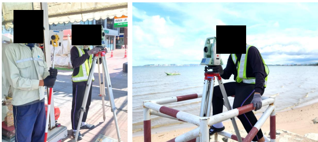
รูปที่ 3.4.7-4 : เครื่องวัดมุม Total Station ยี่ห้อ SATLAB model Satlab: SLT2
